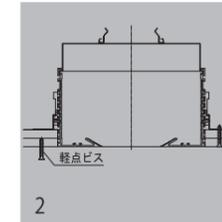
天井上のパンチングメタルに軽天ビスを打ち込みBOXを固定する。
