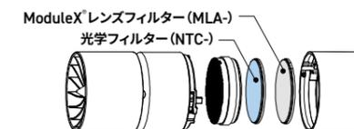
※ ModuleXのレンズフィルター(MLA)と組み合わせて使用する場合、光学フィルター(NTC)は光源側に装着してください。
